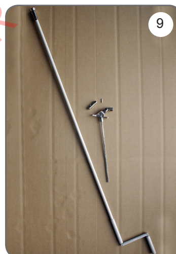
Korba, przegub Cardana 45° lub 90° z zaczepem dzwonicowym [9].
